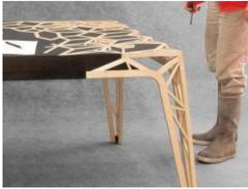
(شكل رقم 10) يظهر من الشكل كيف نجحت تقنية الطباعة ثلاثية الابعاد في انتاج مكونات المنضدة من خامات متعددة وتركيبها معا بكل دقة وتطبيق .
